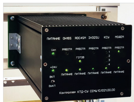
Контроллер, входящий в состав КДК-СУ, устанавливаемый в релейном шкафу
